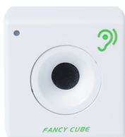
声音传感器 声音传感器用于检测周围环境中的声音强度。
